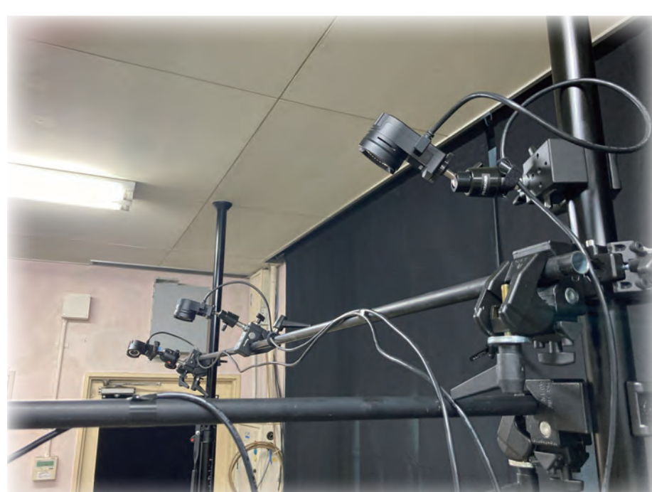
モーションキャプチャ装置 : 複数のカメラで動きを三次元的に捕捉
