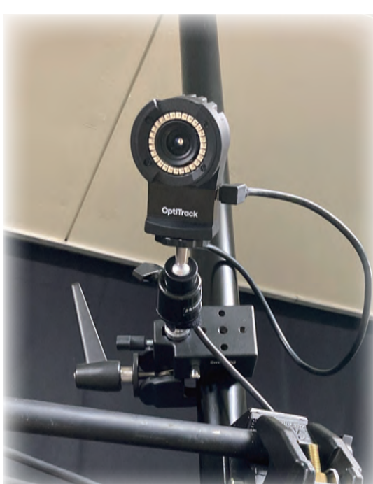
モーションキャプチャ装置 : 複数のカメラで動きを三次元的に捕捉
