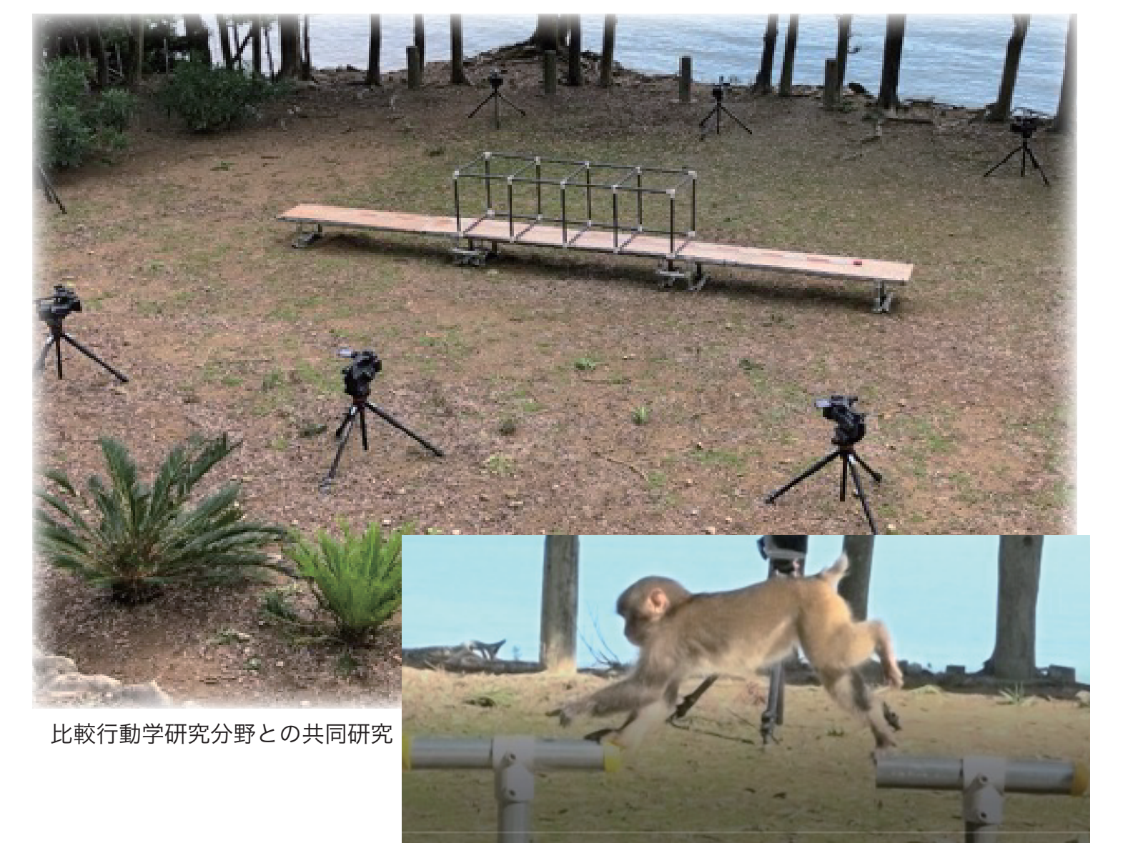
フィールドでの歩行実験: 多様な発達段階のニホンザルで、歩いたり、走ったり、ジャンプしたりする様子を複数のビデオで撮像。多様なロコモーションの運動の仕組みや、その発達を明らかにします。
